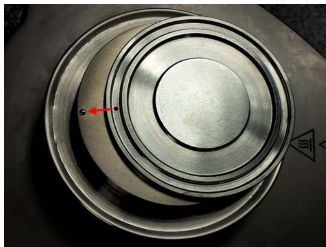
Abbildung 2: Messplattenaufsatz TMP für Platte-Platte- und Kegel-Platte-Messgeometrien mit übereinstimmendem Durchmesser. Mit Nut unterhalb der Markierung, um die TMP einfach und genau auf dem PIN der Temperatureinheit zu positionieren.
