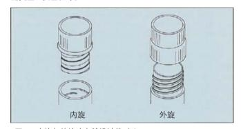
图 4: 内旋与外旋冻存管设计的对比
