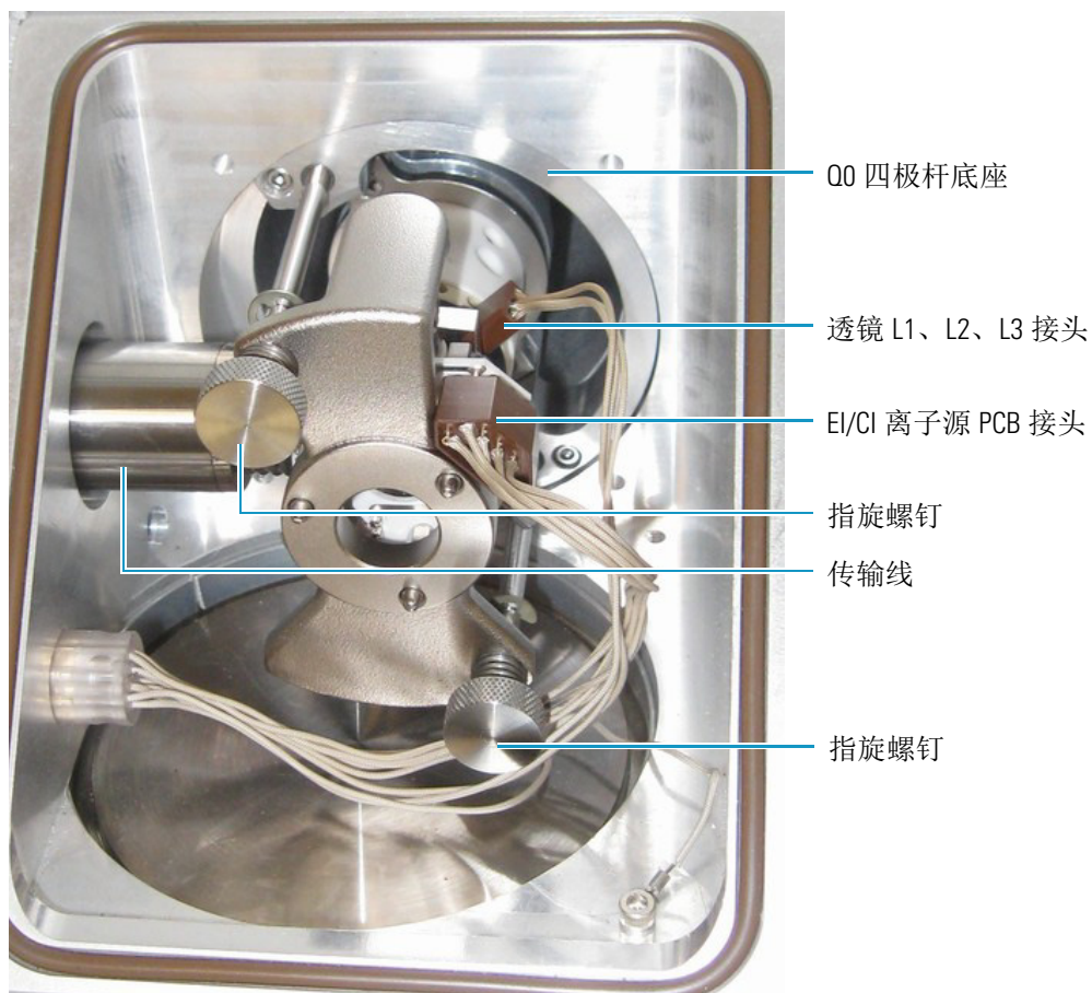
图 51. TSQ Quantum XLS 系列离子源，已安装
