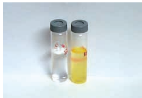
左边为装填氧化铝后在线脱脂的萃取结果，右边为没有在线脱脂的萃取结果，右边的萃取液比较混浊
