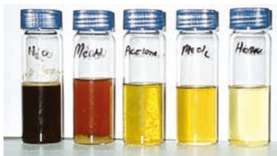
溶剂蒸发器从左至右溶剂的极性逐渐减弱：水、甲醇、丙酮、二氯甲烷、正己烷
