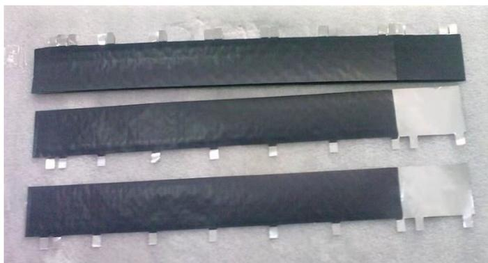
Figura 1. Eletrodos de bateria de íon de lítio
